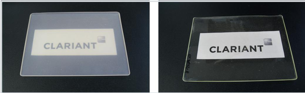
**Bild 2.** Bei dem gehärteten Epoxidharz mit 40 phr ATH (links) kommt es zu einer Trübung durch die beigemischten FSM-Partikel. Das Epoxidharz mit 100 phr Exolit EP 360 (rechts) weist keine Trübung auf © Clariant
